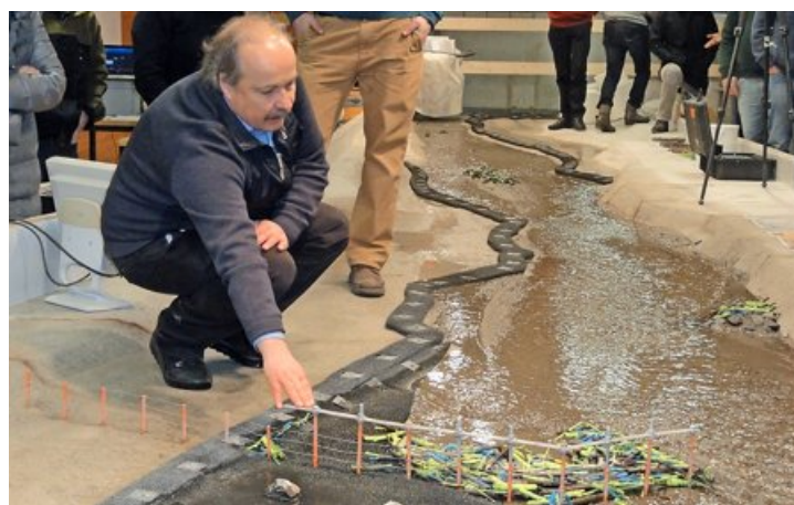
IBU-Institutsleiter Jürg Speerli erklärte die Funktionsweise des Rechens. Die farbigen Stäbchen simulieren im Versuch das Schwemmholz.
