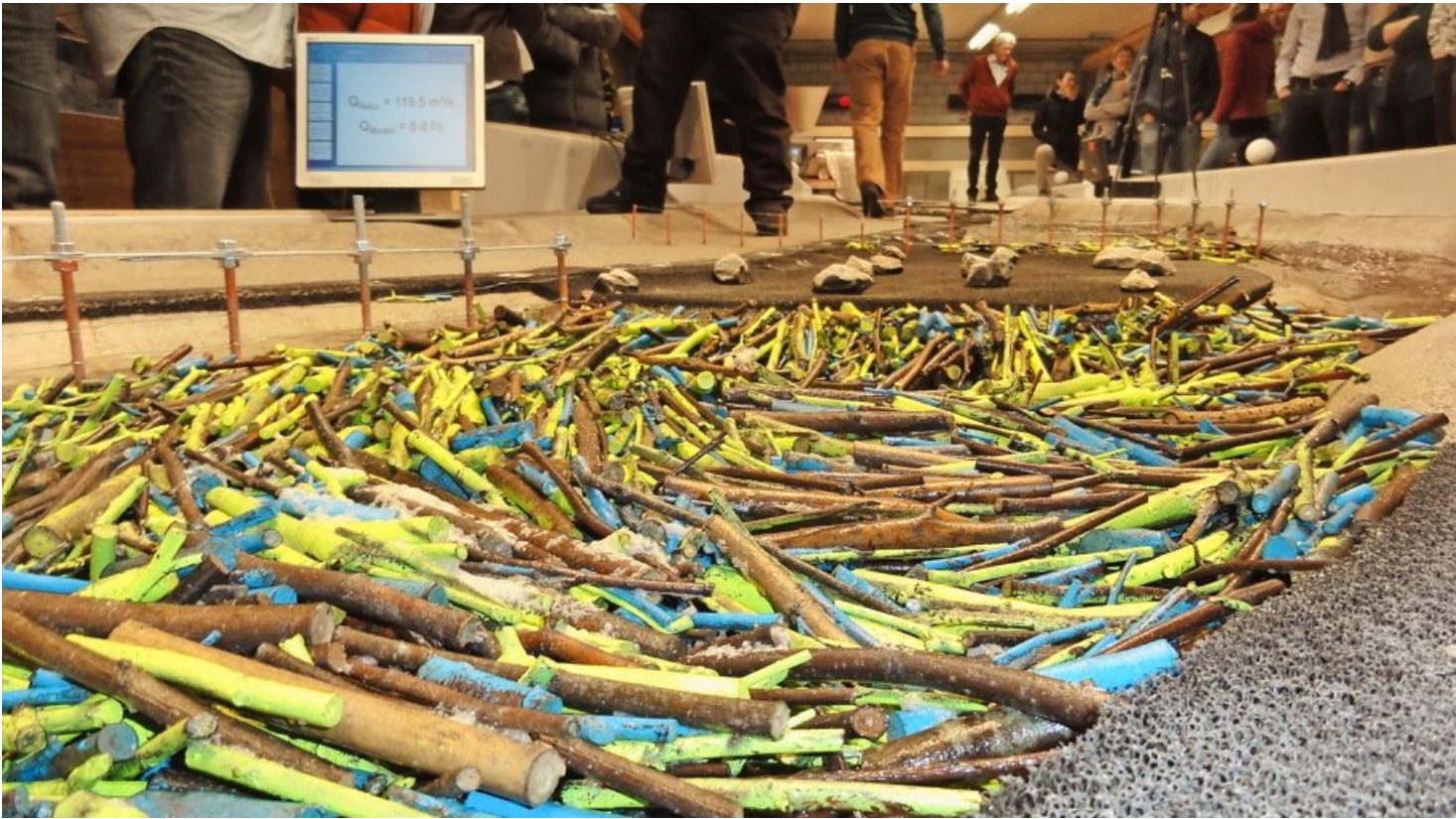
Die vielen bunten Hölzchen symbolisieren angespültes Schwemmholtz im Modellversuch für den Holzrückhalterechen in der Zulg. Die Tests wurden an der Hochschule für Technik in Rapperswil durchgeführt.
